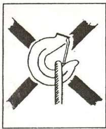
kuva 3 a koukkuja saa kuormittaa vain suorassa vetolinjassa
