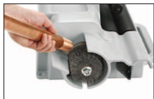
Lisävarusteena saatavalla purseenpoistolaikalla hiotaan ulkoreunat helpottamaan tiukkojen liitosten asennusta
