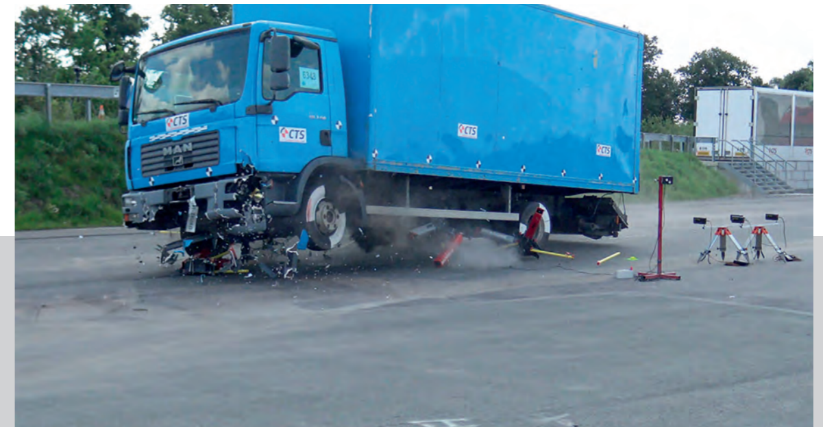
Turva-aitaan törmännyt ajoneuvo pysähtyy ja tuhoutuu ajokelvottomaksi.
